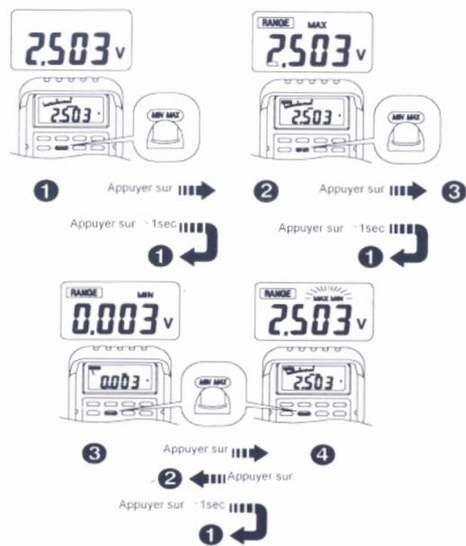
**Remarque :** lorsque vous appuyez sur le bouton **HOLD (Retenue)** en mode **MIN MAX**, le multimètre cesse de mettre à jour les valeurs maximum et minimum. Pour désactiver le mode **MIN MAX** lorsque le mode **Hold (Retenue)** de l'affichage est intégré au mode **MIN MAX**, désactivez d'abord l'affichage.
