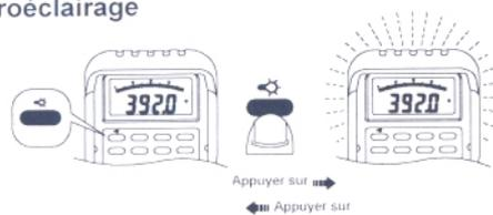
**Remarque :** appuyez sur le *bouton Backlight (Rétroéclairage)* pour activer/désactiver le rétroéclairage.
